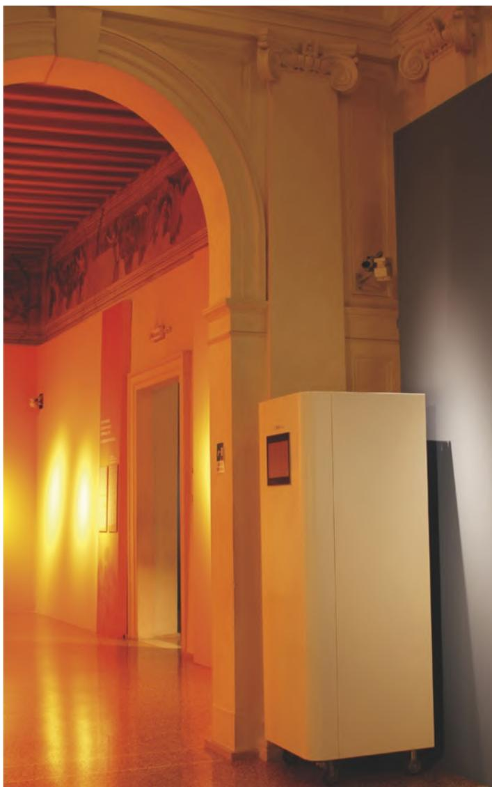
Situato nella sala al primo piano, Jonix Mate è un apparecchio per la filtrazione e sanificazione dell'aria dotato di un proprio gruppo di ventilazione gestito dal software di controllo (Jonix).
