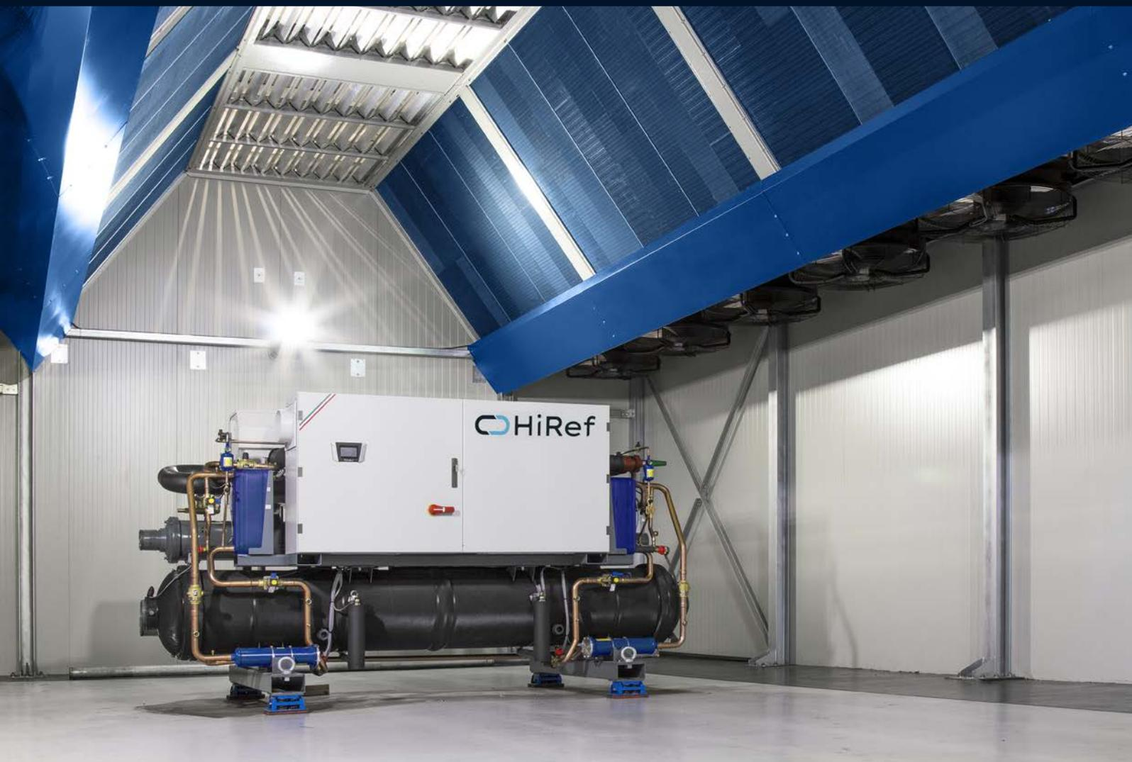
Das vollständig von der R&D Struktur von HiRef neu entwickelte **Hyper Lab** ist für die Prüfung von Luft/Wasser, Wasser/Wasser Kaltwassererzeugern und Wärmepumpen, von Luft/Luft Einheiten mit großen Abmessungen (HiRef DataBatic) und hohen Leistungen (bis 1,5 MW nominale Kälteleistung und 2,0 MW Wärmeleistung) konzipiert. Im Falle von Luft/Luft Geräten kann der Außenbereich (Außenluftanschluss) mit Temperaturen bis  $-35^{\circ}\text{C}$  simuliert werden.
