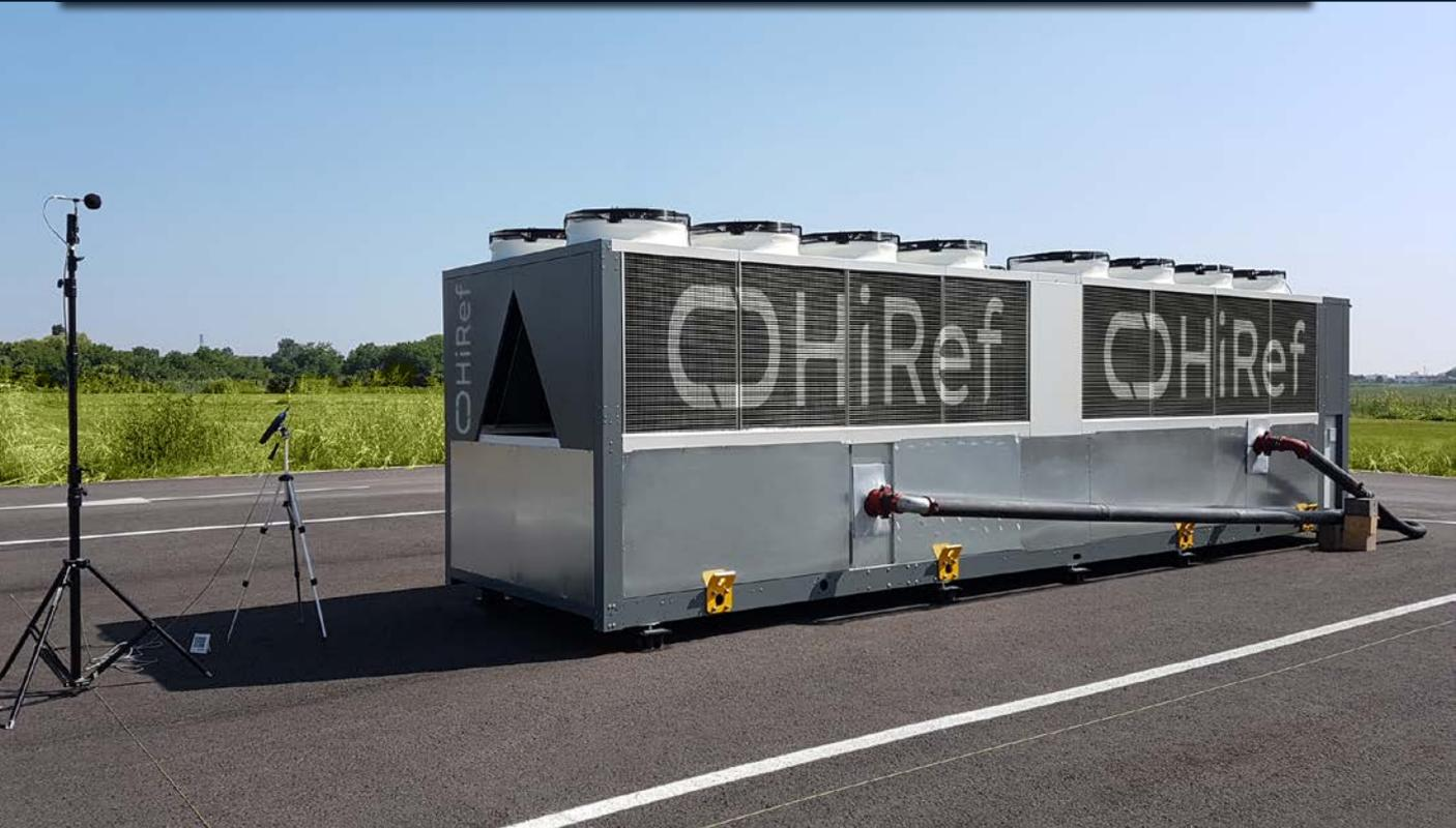
Dank der engen Zusammenarbeit mit der nahen Universität Padua kann für die Zertifizierung der Schalltests, die in einem nach UNI EN ISO 3746 qualifizierten Außenbereich durchgeführt werden, akademisches Lehrpersonal hinzugezogen werden. Die angewendete Instrumentierung mit Präzisionsklasse 1 erlaubt unter günstigen Umweltbedingungen eine Genauigkeit von 1.5 dBA.
