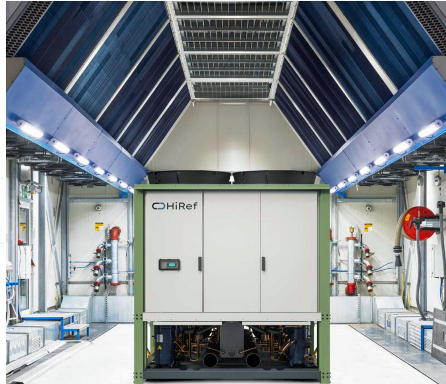
Durante el **FAT**, se comprueba que el producto cumpla con los requisitos técnicos, las especificaciones contractuales y que funcione correctamente en condiciones simuladas, garantizando **la calidad y fiabilidad** del producto final.
