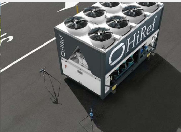
HiRef garantisce un range di accuratezza minimo di tutte le misurazioni secondo la norma UNI EN 14511-3. La strumentazione viene sottoposta a rigorosi e periodici controlli che ne assicurano la taratura. Inoltre, l'intera catena di misura viene calibrata in fase di taratura dei singoli strumenti.
