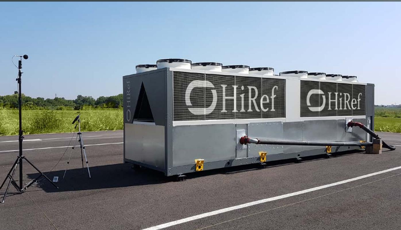
Grazie alla stretta collaborazione con il vicino Ateneo di Padova, è possibile disporre di personale accademico per la certificazione dei test acustici che vengono condotti in un'area esterna qualificata in conformità con la norma UNI EN ISO 3746. La strumentazione adottata di classe di precisione 1 consente un'accuratezza di 1.5 dBA in condizioni ambientali favorevoli.
