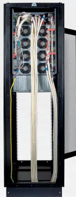
Esempio di integrazione (3x25 kW). Solo 15U di rack occupate: il design compatto lascia spazio per altri dispositivi montati a rack. Uno slot vuoto nel subrack MODULYS RM GP resta disponibile per aumento della potenza o per ridondanza.
