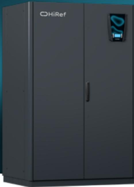
TREF DX D/K/Q sono unità Dual Cooling. Abbinano alla tradizionale batteria evaporativa del circuito frigo, l'effetto frigorifero dell'acqua refrigerata proveniente da un'unità esterna come un chiller. L'utilizzo di una doppia fonte permette di garantire continuità al sistema e di scegliere in ogni occasione la migliore soluzione operativa, al fine di minimizzare i costi di esercizio.
