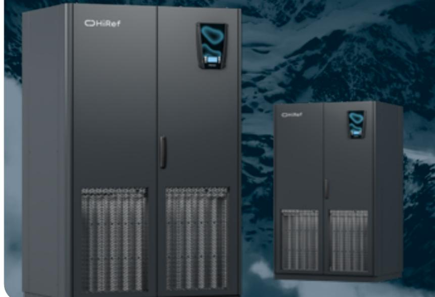
Gli **NRG W/Z** sono armadi perimetrali condensati ad acqua. La **serie W** utilizza acqua di Dry Cooler, la **serie Z** utilizza acqua di rete o di falda a bassa temperatura (15°C). Gli **NRG** di queste serie sono unità monoblocco al cui interno si concentra tutto il circuito frigo, la condensazione avviene grazie a uno scambiatore a piastre saldobrasate in acciaio inossidabile AISI 304.
