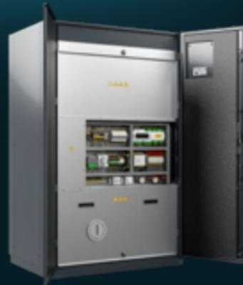
TREF DX W/Z sono armadi perimetrali condensati ad acqua. La **serie W** utilizza acqua di Dry Cooler. La **serie Z** utilizza acqua di rete o di falda a bassa temperatura (15°C). I TREF di queste serie sono unità monoblocco al cui interno si concentra tutto il circuito frigo. La condensazione avviene grazie a uno scambiatore a piastre saldobrasate in acciaio inossidabile AISI 304.
