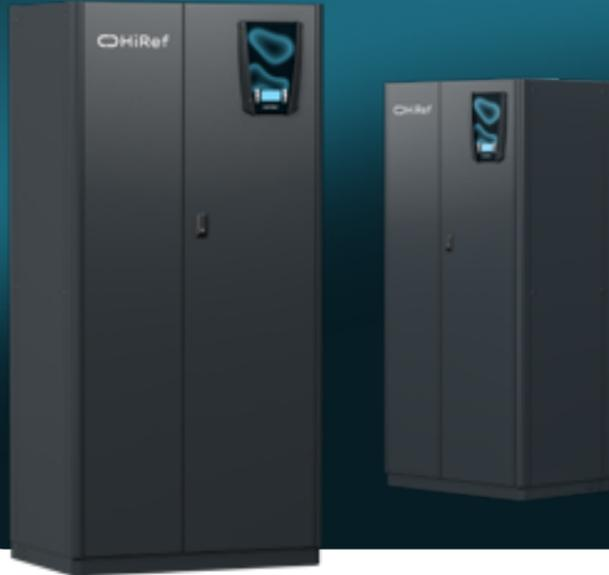
Le unità **JREF W/Z Radiali** sono armadi perimetrali condensati ad acqua. La serie W utilizza acqua di Dry Cooler. La serie Z utilizza acqua di rete o di falda a bassa temperatura (15°C). I JREF di queste serie sono unità monoblocco al cui interno si concentra tutto il circuito frigo. La condensazione avviene grazie a uno scambiatore a piastre saldobrasate in acciaio inossidabile AISI 304.
