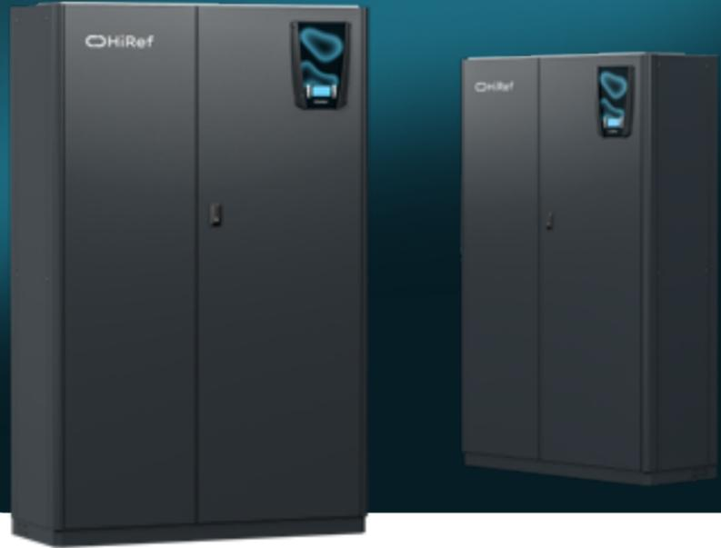
Le unità **JREF W/Z Centrifughi** sono armadi perimetrali condensati ad acqua. La **serie W** utilizza acqua di Dry Cooler. La **serie Z** utilizza acqua di rete o di falda a bassa temperatura (15°C). I JREF di queste serie sono unità monoblocco al cui interno si concentra tutto il circuito frigo. La condensazione avviene grazie a uno scambiatore a piastre saldobrasate in acciaio inossidabile AISI 304.
