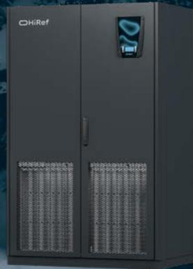
Gli NRG W sono armadi perimetrali condensati ad acqua che utilizzano acqua di Dry Cooler. Gli NRG di questa serie sono unità monoblocco al cui interno si concentra **tutto il circuito frigo**, la condensazione avviene grazie a uno **scambiatore a piastre saldobrasate in acciaio inossidabile AISI 304**.
