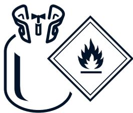
I refrigeranti di classe ASHRAE A2L sono blandamente infiammabili. Questa caratteristica impone che l'unità di condizionamento presenti alcuni accorgimenti, a livello di sensoristica e componentistica: **il rischio di innesco fiamma è dunque evitato preventivamente, tramite un'adeguata progettazione.**
