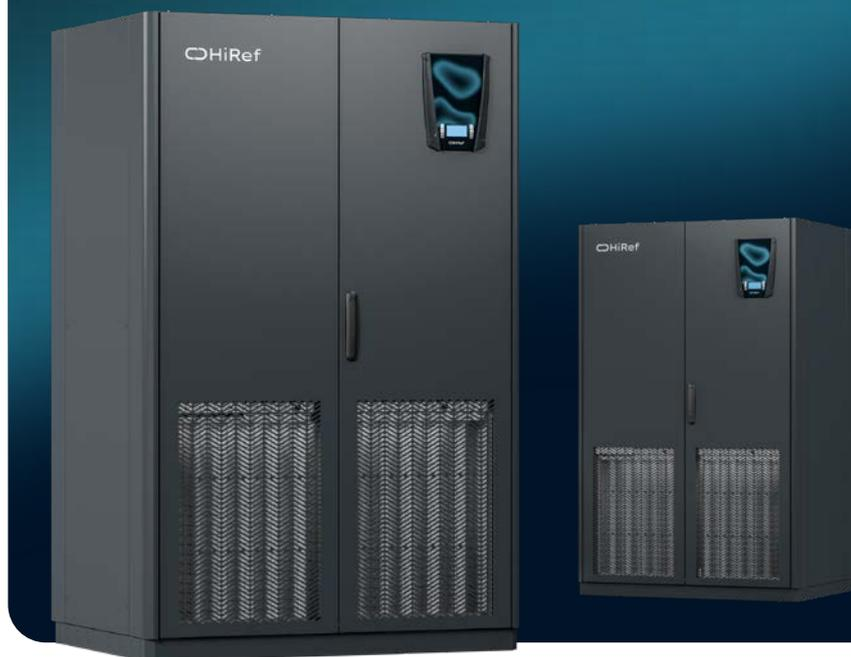
NRG D/K/Q sono unità Dual Cooling. Abbinano alla tradizionale batteria evaporativa del circuito frigo, **l'effetto frigorifero dell'acqua refrigerata**, proveniente da un'unità esterna come un chiller. L'utilizzo di una doppia fonte permette di garantire **continuità al sistema** e di **scegliere in ogni occasione la migliore soluzione operativa**, al fine di **minimizzare i costi di esercizio**.
